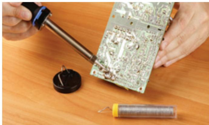
Представлены четыре серии паяльников, имеющих деревянную, пластмассовую или двухкомпонентную (пластмасса и обрезиненная часть) рукоятку. Каждый паяльник оснащен надежной евровилкой и медным жалом «Long Life» со специальным покрытием, обеспечивающим долговечность и надежность изделия. Напряжение питания: 220 В/ 50 Гц.
